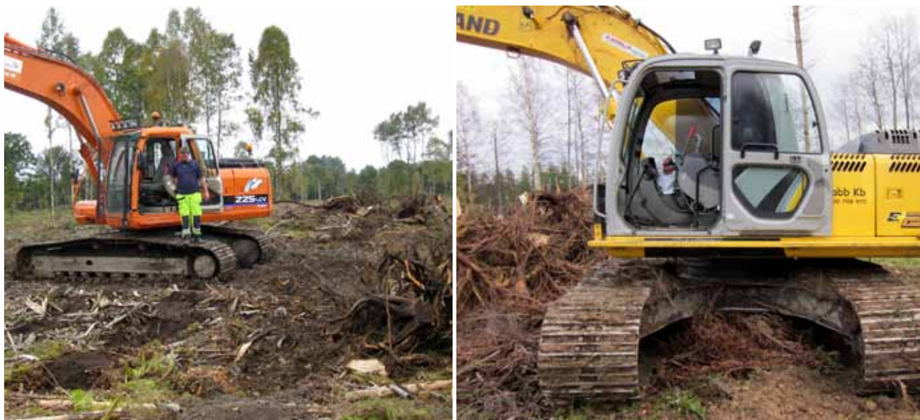
Figur 1. Vid skördning av stubbar används grävmaskin och instegen är höga.
